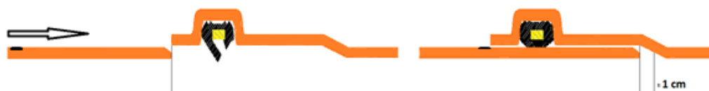
Figura 2 - Esquema de montagem de uma união com o-ring labial
