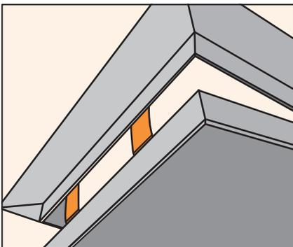
**Sistema de apertura parcial mediante retención de dos topes de acero.**
