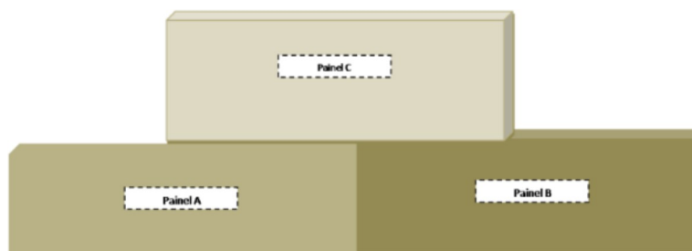
Fig. 44 – Forma de colocação do painel sandwich Ondutherm
