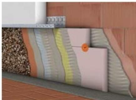
Malla de fibra de vidrio denominada "antivandálica" indicada para el refuerzo de zonas expuestas a altos niveles de tensión, especialmente zócalos. Puede utilizarse junto o en sustitución de otras mallas para fachadas. Certificado según ETAG 004.
