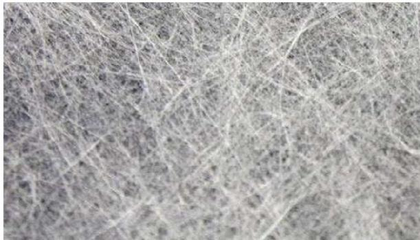
Velo de fibra de vidrio clase C formulado para el refuerzo en impermeabilizaciones de terrazas, cubiertas planas e irregulares, moldeo, piscinas, náutica, etc.
