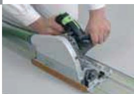
Serra circular de folha de carbureto para recortar o painel
