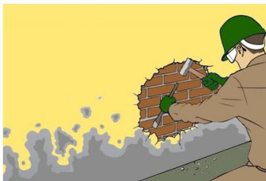
O reboco degradado, solto e com elevada carga de sais deve ser retirado por picagem até 50 cm acima da parte húmida visível.
