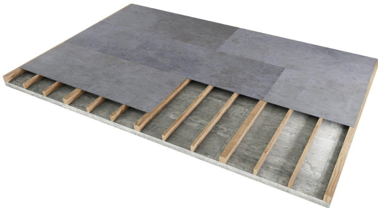
Figura 4.1 – Pavimento Viroc apoiado sobre vigas
